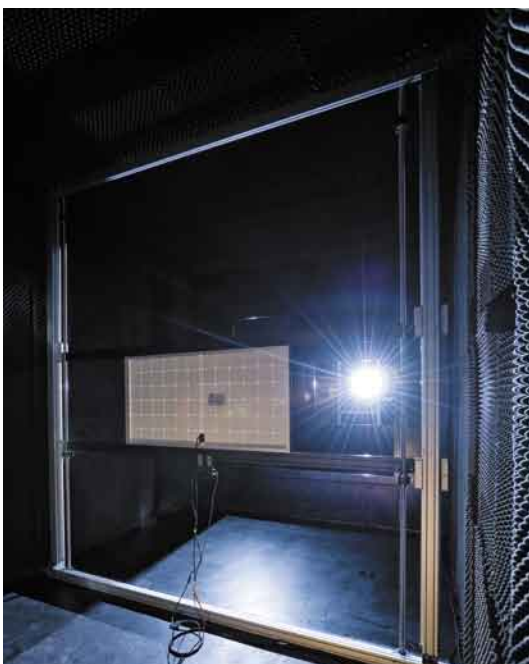
Mesures effectuées dans le laboratoire PHOTON : La puissance STC d'un panneau solaire est mesurée par le « flasher » en quelques fragments de seconde. Le calcul de l'énergie produite nécessite davantage de temps, c'est-à-dire une année entière sur le banc d'essai en plein air.
