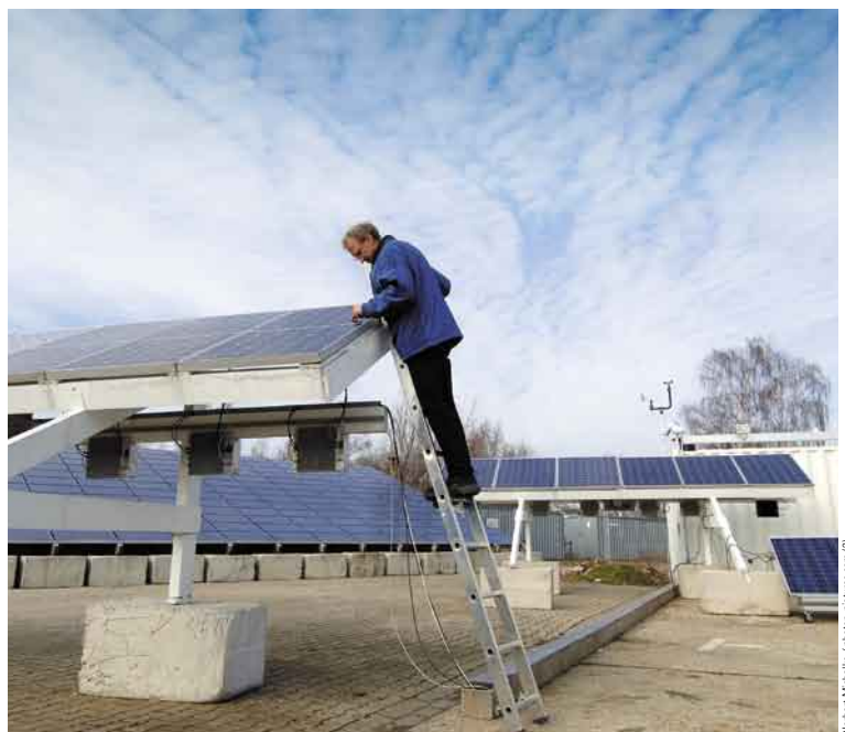
Mesures effectuées dans le laboratoire PHOTON : La puissance STC d'un panneau solaire est mesurée par le « flasher » en quelques fragments de seconde. Le calcul de l'énergie produite nécessite davantage de temps, c'est-à-dire une année entière sur le banc d'essai en plein air.
