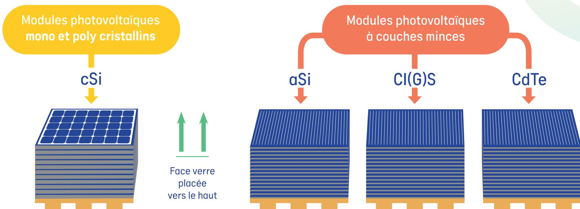
Les panneaux photovoltaïques doivent être **propres, complets** et **stockés à l'abri de l'eau**.
